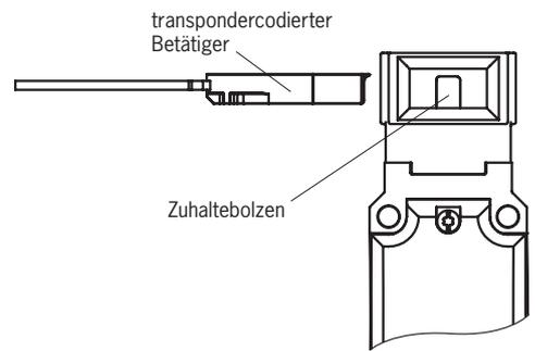
Beim Schließen der Schutzeinrichtung wird der Betätiger in den Sicherheitsschalter eingeführt. Beim Erreichen des Einschaltabstandes erfolgt über den Schalter die Spannungsversorgung zum Betätiger und die Datenübertragung erfolgt.
