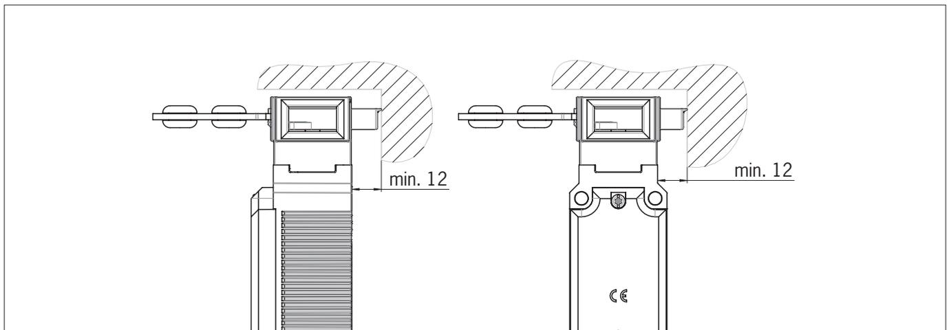
Bild 2: Freiraum Betätigerkopf
