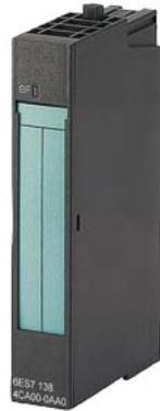
SIMATIC DP, Elektronikmodul 2 AO I High Feature für ET 200S, 15mm Baubr., Zykluszeit pro Modul: 0,5ms, +/-20mA; 15 Bit+VZ, 4.. 20mA; 15 Bit
